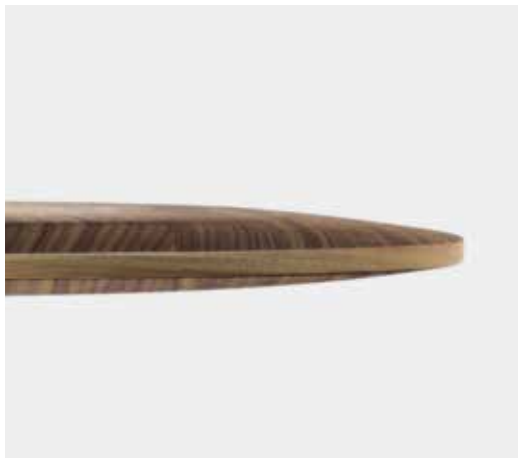
Profil de plateau symétrique en aile d'avion sur âme en médium, épaisseur 26 mm, finition ébénisterie selon nuancier Wilkhahn
